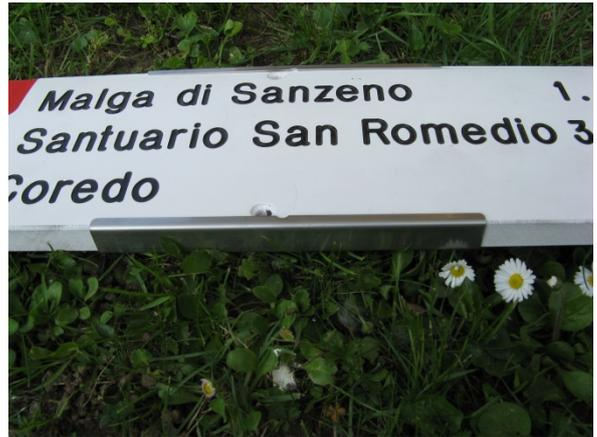
A causa delle numerose rotture che si sono verificate sulle tabelle in Forex (circa l'1% delle stesse), presso il laboratorio della Latif (Laboratorio Tecnologico Impianti a Fune) di Trento sono stati fatti test per saggiarne resistenza alla trazione e flessione.
