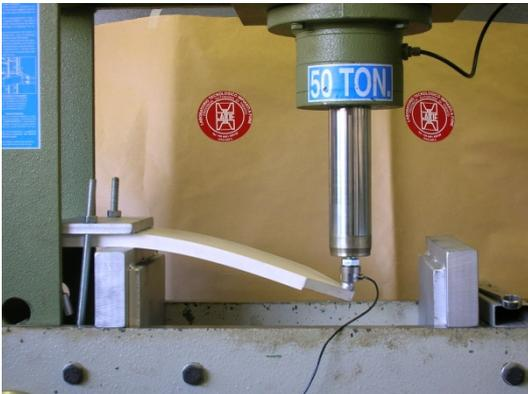
Dalle prove condotte emerge chiaramente, ai fini della robustezza della tabella in Forex, la necessità della collocazione della stessa su una superficie sufficientemente larga da sostenerne effetti di trazione.
